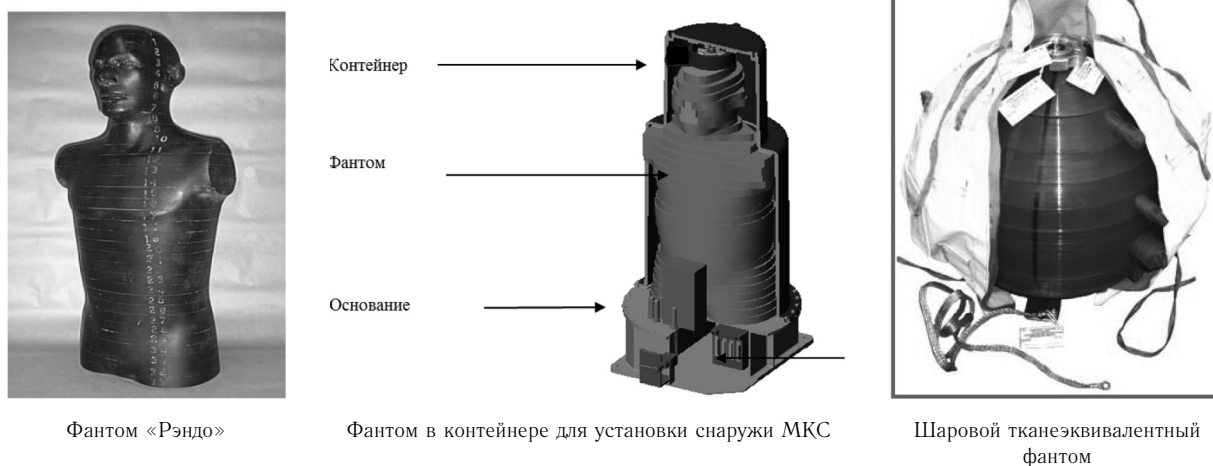
Рис. 2. Примеры тканеэквивалентных фантомов космического эксперимента «Матрешка-Р»
